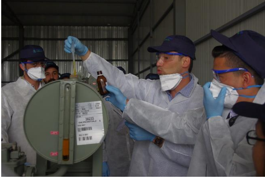
Şekil 2.5 Trafonun Üst Kısımından Numune Alınması
