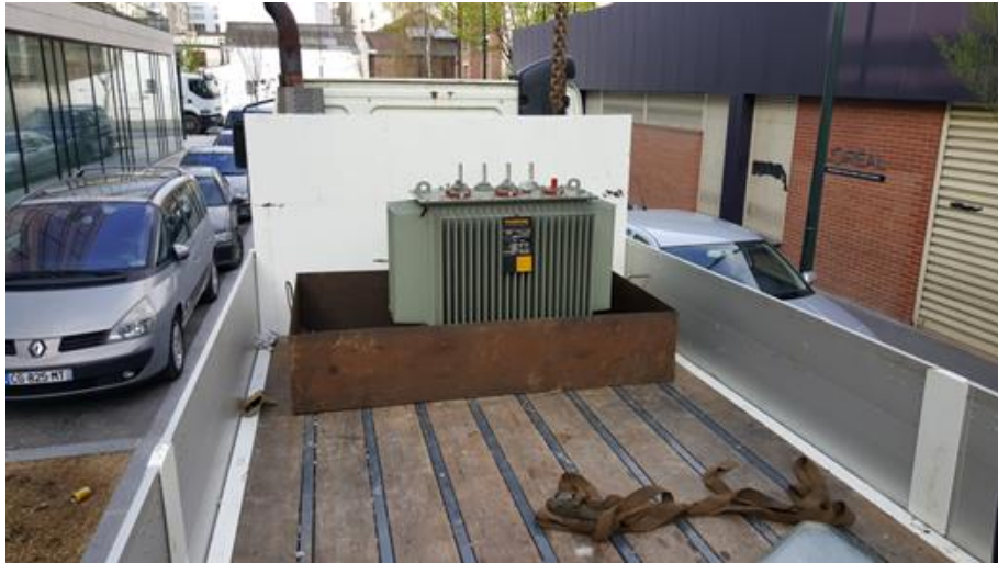
Şekil 5.7 Çelik muhafaza tanklı kamyon platformu
