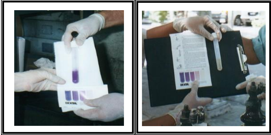
Şekil 2.15 Tek Kullanımlık Test kiti (Clor-N-Oil) Negatif Sonuç (Sol), Pozitif sonuç (Sağ)
