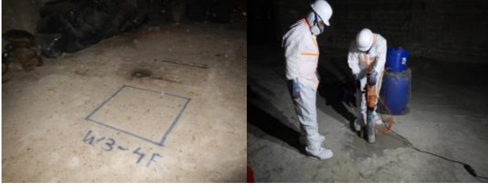
Şekil 5.5 Zeminlerdeki malzeme ağırlığı (sol) Beton karot örneği (sağ)
