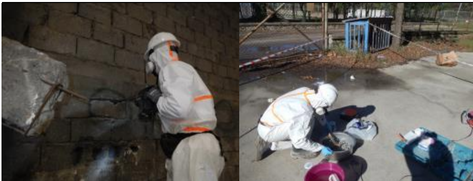
Şekil 5.6 Yapı taşlarının toplanması (sol) Laboratuvara transferden önce bloklara dışarda yapılan işlemler (sağda)
